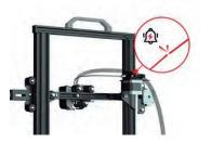
Sensor de detección de filamentos El sensor de detección de filamentos ayuda a detectar y notificar el uso de filamentos durante la impresión 3D.
